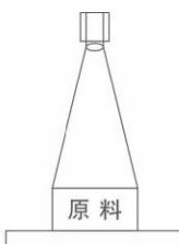
通过对不规则的原料肉进行**二维测量**，经过软件分析计算，确定产品的切割长度，对产品进行**垂直切割**或者**斜切割**，从而确保切割后每一块产品的**重量一致**，或者切割出产品要求的配方重量。适用于新鲜原料（解冻）厚度≤50mm的切割生产，主要用于**鱼类**及**家禽类**产品的切割。如：鱼片、鱼排、鸡块、鸡排等。
