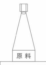
通过对不规则原料进行测量，经过软件分析计算，确定产品的切割厚度，对产品进行水平切割，从而确保准确的厚度要求或者重量要求。与智能切割机连接可实现鸡腿排的自动化切割加工。适用于家禽类及鱼类产品的水平切割。
